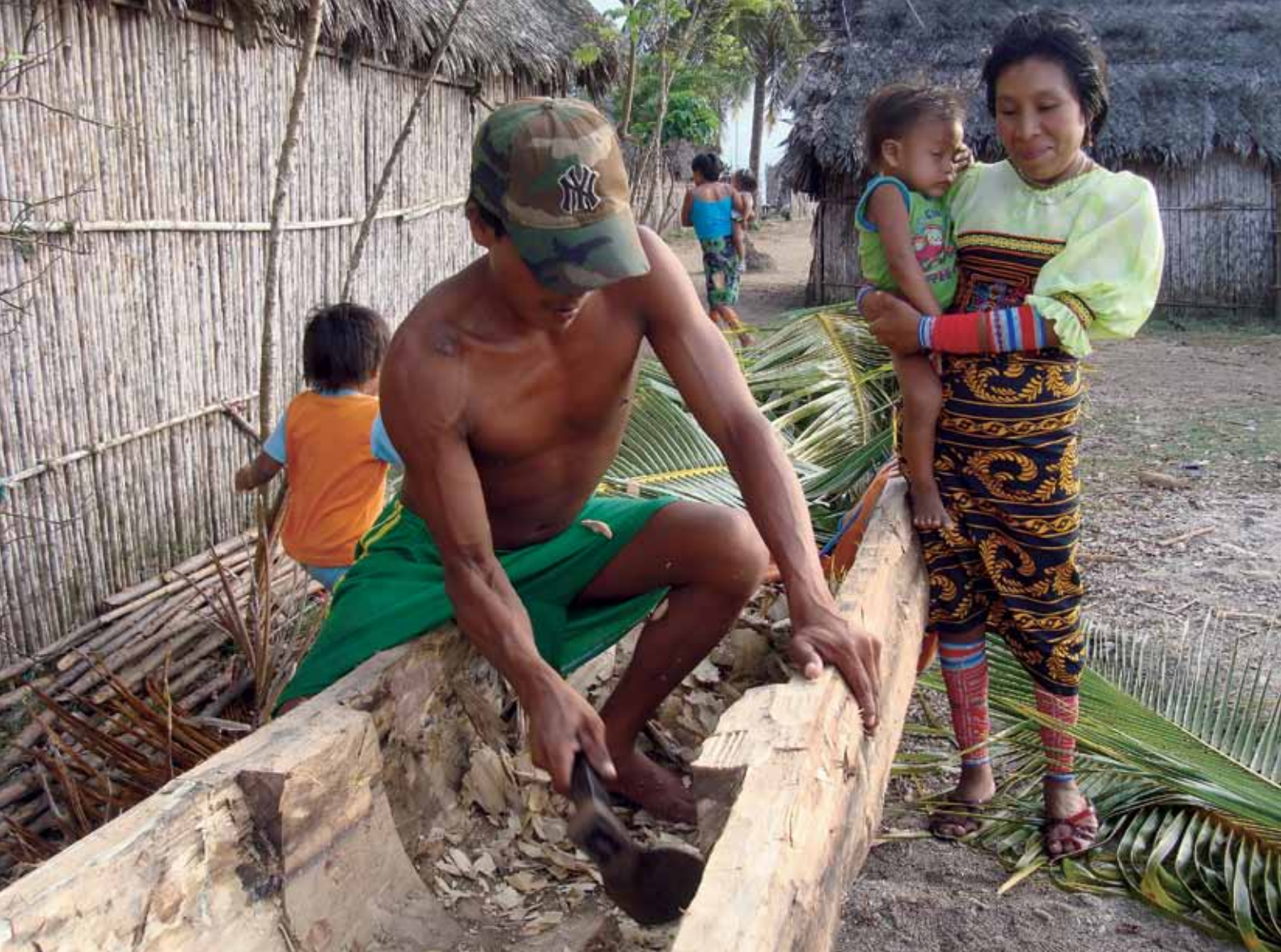
L'ulu est taillé dans un seul tronc d'arbre, creusé à l'herminette et à la machette. Îles Robesson.
