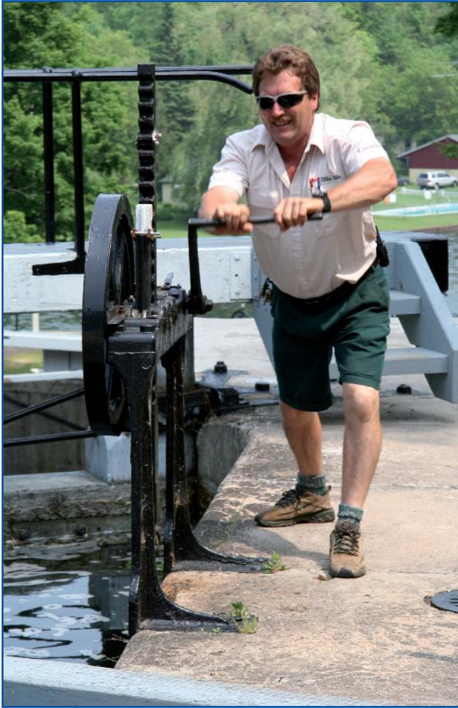
Toutes les écluses sont manœuvrées manuellement avec les systèmes utilisés vers la fin du XIX e siècle.
