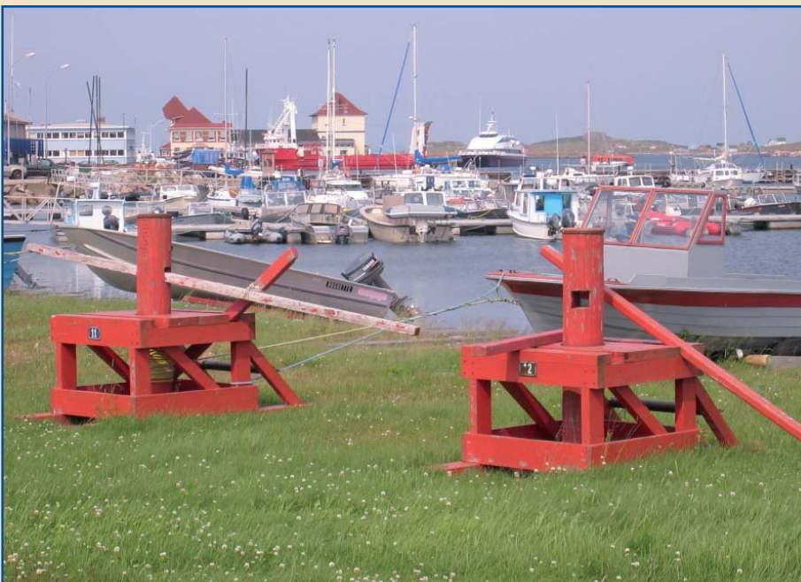
Les cabestans de bois sont toujours fonctionnels et servent à halier les embarcations sur le rivage.
