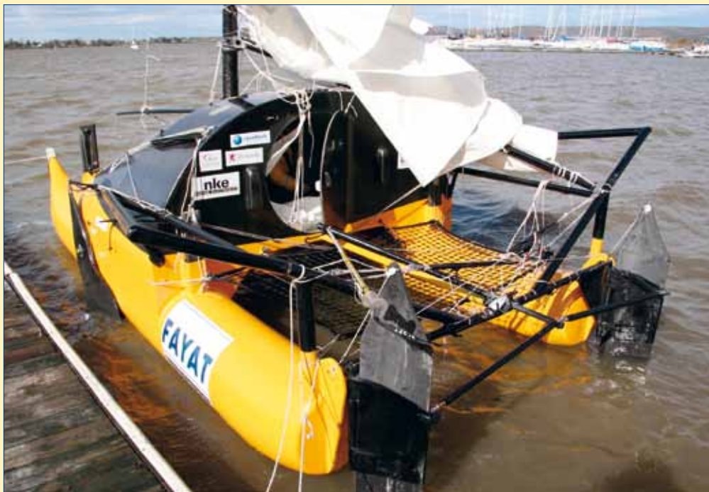
Le trampoliner et l'accès à l'habitacle. Beaucoup d'éléments ont été fabriqués à partir de fibre de carbone.
