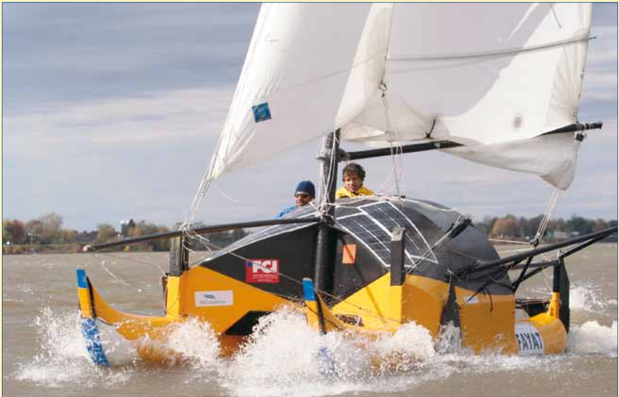
Le rouf volumineux servira d'abri aux navigateurs polaires. On voit très bien devant le rouf les poutres qui servent à déployer les skis et en arrière-plan les palans qui les contrôlent.
