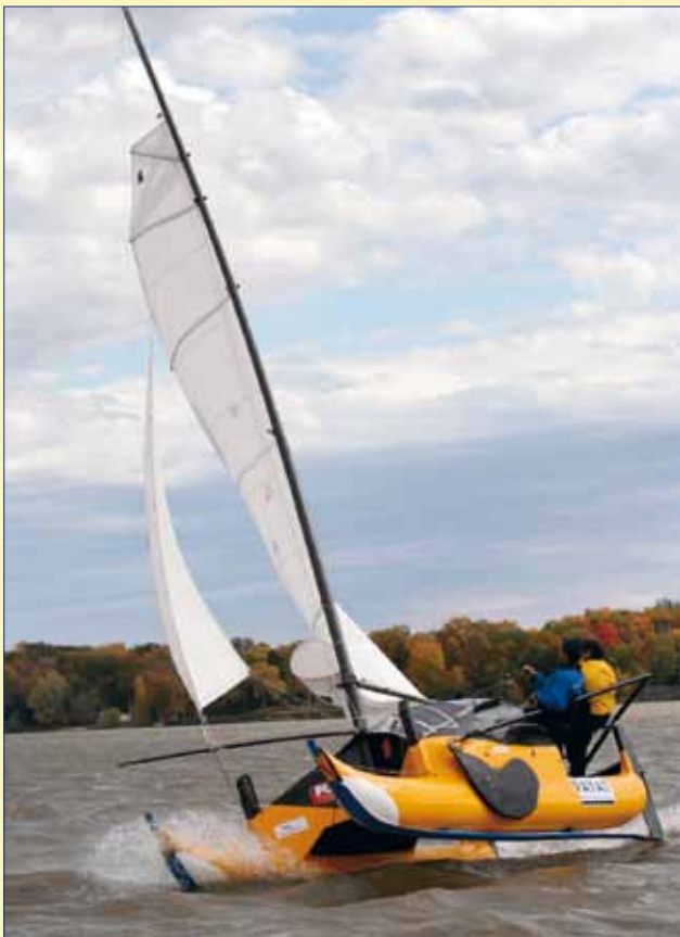
Le mât non haubanné déverse volontiers et soulage automatiquement le plan de voile dans les risées.
