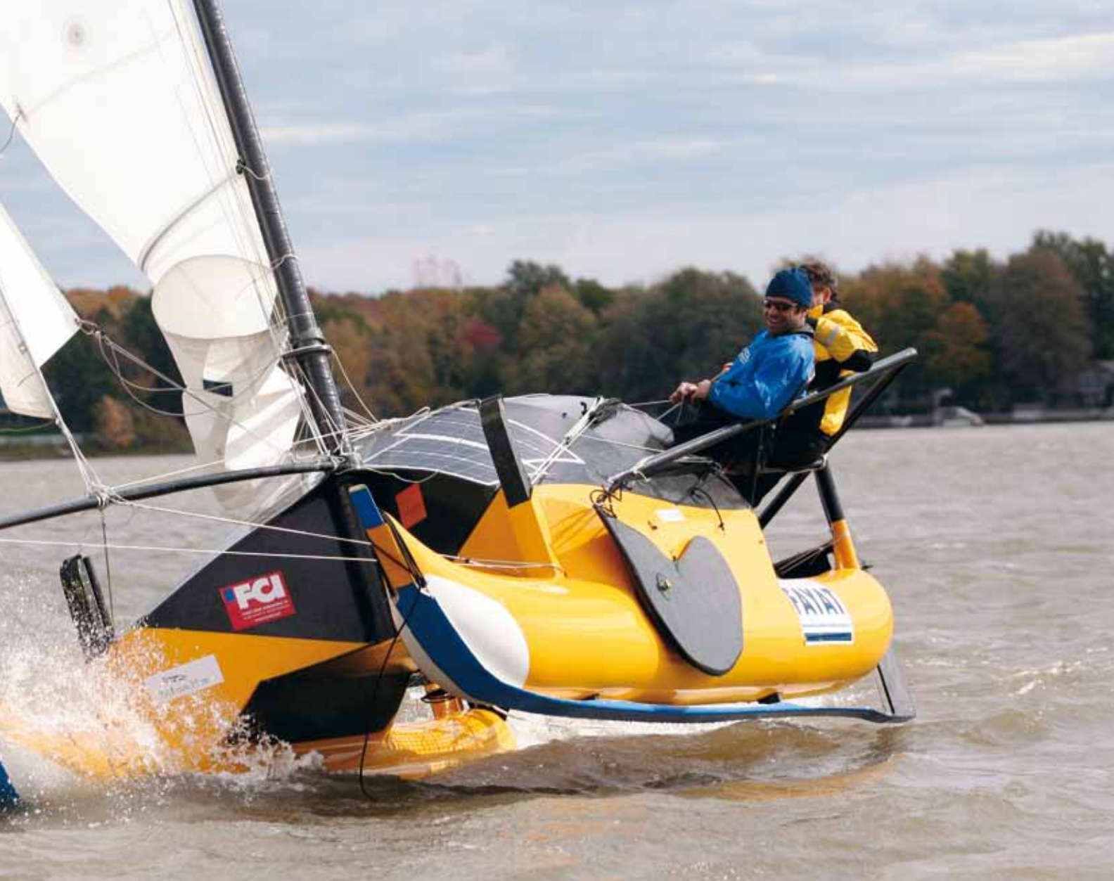
Le catamaran lève une coque et l'on aperçoit distinctement le ski qui court de l'étrave au safran pour naviguer sur la glace.
