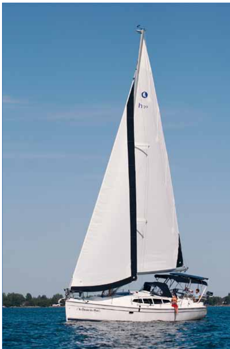
Le Hunter 39 présente un petit triangle avant qui facilite les virements de bord. Notez la position très avancée du mât sur le pont et la superficie de la grand-voile, 1,5 fois plus grande que le foc.
