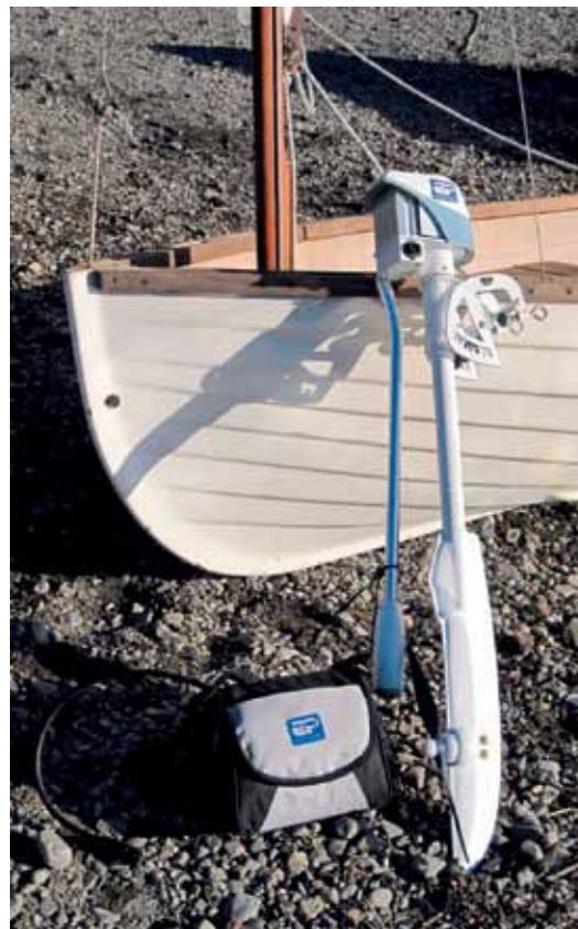
La barre à gouverner se replie le long de l'arbre pour faciliter le transport. Sorti de son sac, le moteur est en état de marche en quelques instants à peine.
